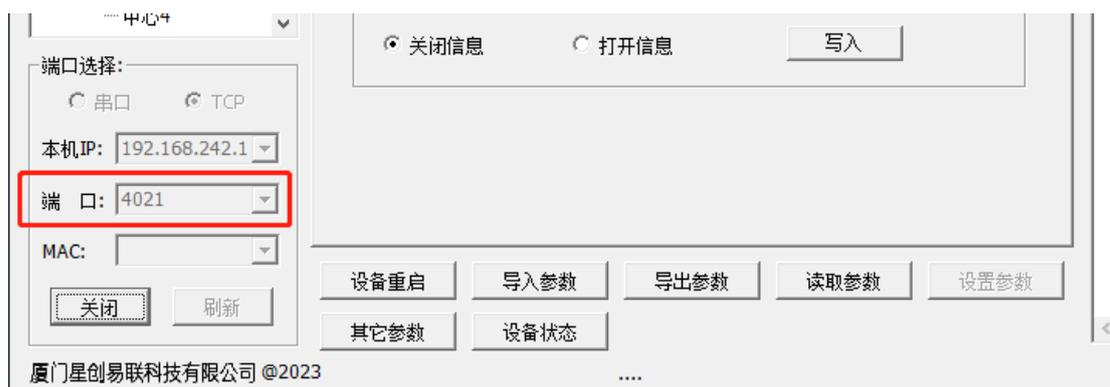
本机 IP 一般使用默认值，如果服务器有多个网络接口，选择对应的内网 IP。
