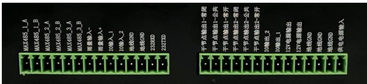
如仅需接入一个功耗不超过 20W 的 12V RS485 传感器，请按以下表格接线。若传感器功耗超过 20W，请单独为传感器供电，或与充放电控制器并联供电。
