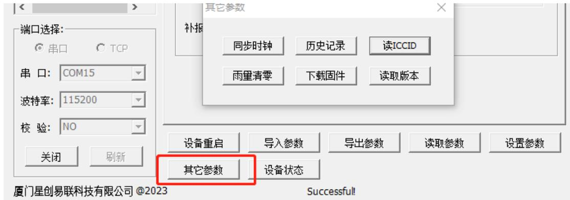
**同步时钟：**设备通常能够通过联网自动对时，但若设备长时间未联网，可能会导致时间不准确。同步时钟功能可将电脑当前时间同步给 RTU。
