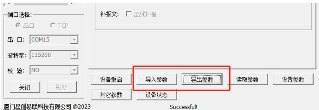
导入和导出参数适用于相同项目和传感器，导入后，通常只需修改传输配置中的地址即可。
