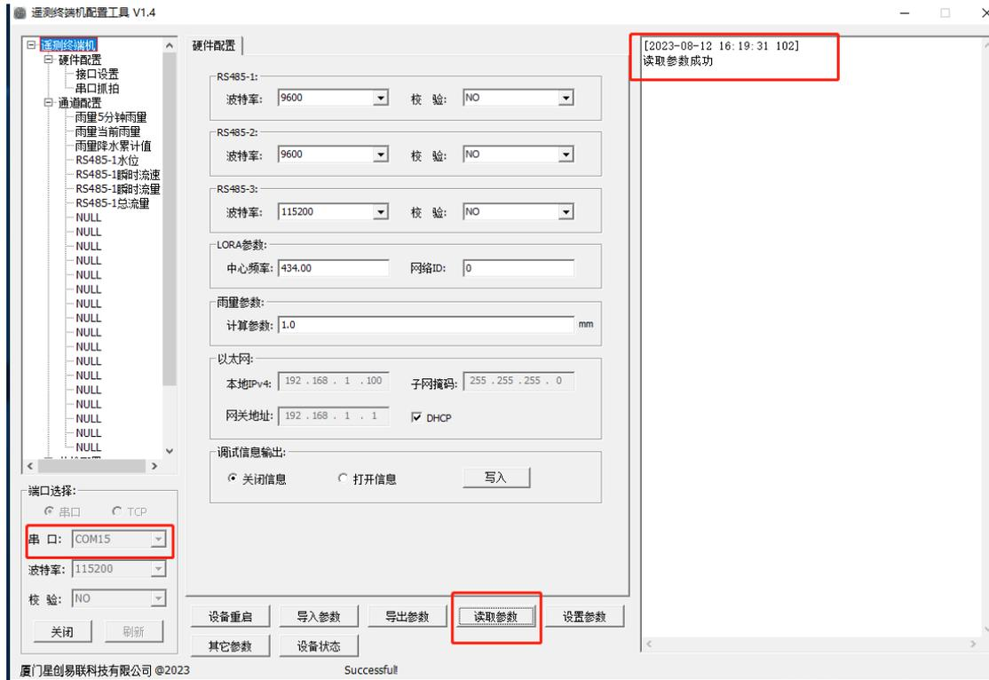
备注：串口（COM 口）是串行通讯端口，常用于连接各种通讯设备如鼠标。支持多种协议，如 RS-232-C、RS-422、RS-485、TTL、USB 等。电脑有多个串口时，可寻找标有“Prolific PL2303GL USB Serial COM Port”的串口，并选择对应串口号。
